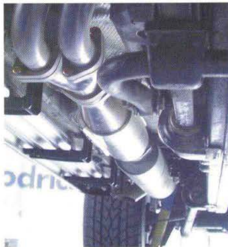
Die Auspuffanlage aus Edelstahl verfügt über vier Kats und mündet in einen zweikammerigen Endschalldämpfer. Der V12 ist mit 8x18 Zoll Felgen bestückt, als Reifen kommen Pneus der Dimension 285/60/18 zum Einsatz, die bis zu einer Höchstgeschwindigkeit von 210 km/h freigegeben sind.
