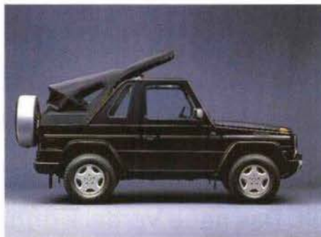
Das neue elektrohydraulisch betätigte Cabriovertdeck für den G 300 DT und G 320 öffnet sich in 30 Sekunden. Lediglich zum Schließen muß es am Scheibenrahmen von Hand noch verriegelt werden.
