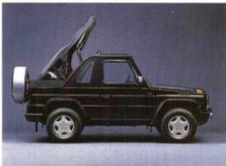
Das neue elektrohydraulisch betätigte Cabriovertdeck für den G 300 DT und G 320 öffnet sich in 30 Sekunden. Lediglich zum Schließen muß es am Scheibenrahmen von Hand noch verriegelt werden.
