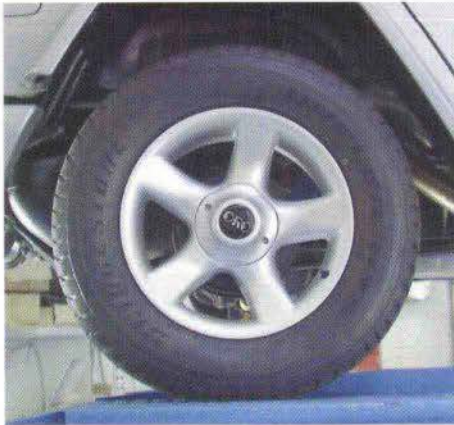
Die Auspuffanlage aus Edelstahl verfügt über vier Kats und mündet in einen zweikammerigen Endschalldämpfer. Der V12 ist mit 8x18 Zoll Felgen bestückt, als Reifen kommen Pneus der Dimension 285/60/18 zum Einsatz, die bis zu einer Höchstgeschwindigkeit von 210 km/h freigegeben sind.
