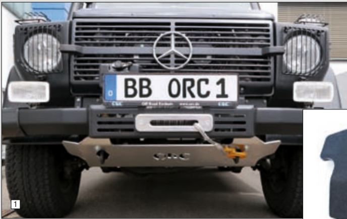
ORC Unterfahrschutz vorne/ORC underride protection front 8 mm Aluminium-Magnesium-Silicium-Legierung 8 mm alloy-magnesium-silicium-composition
