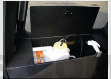
ORC Wasserkanister mit Brauseanschluss in der Staubox über dem Radlauf ORC water canister with sprinker attachment in the storage box over the wheel house
