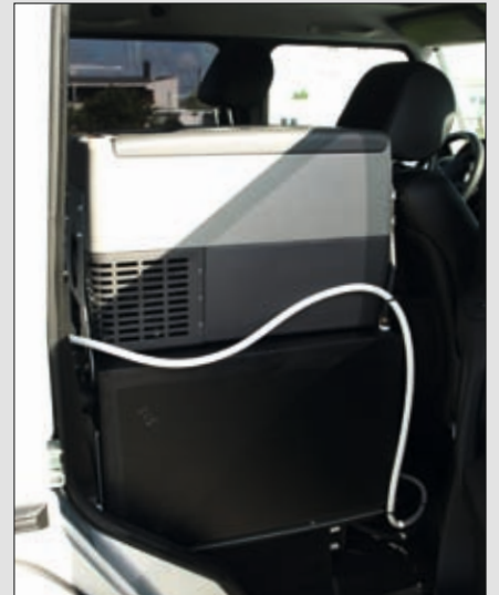
ORC Wassertank ca. 80 Ltr. und Kompressorkühlbox ORC water tank ca. 80l and compressor cool box
