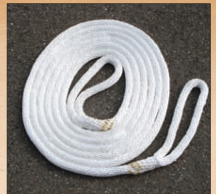
Polyamid-Berggurt/polyamid rope 9 m x 22 mm, Bruchlast 9, t Durch eine Arbeitsdehnung von mind. 20 % erreicht man bei Bergeaktionen den gewün- schten „Gummibandeffekt“. Das Bergeseil ist auch für Schleppaktionen geeignet.
